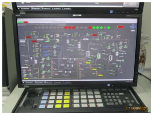
รูปที่ 6 จอแสดงการรวบรวมสาร VOCs จากกระบวนการผลิตและดึงเก็บเพื่อนำไปทำลายที่หอเผา
